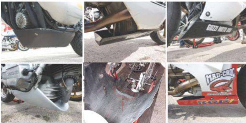
Si el paso de los colectores de escape impiden el cierre trasero de la bandeja, se habilitará en el interior un tabique de contención. (foto 5)
