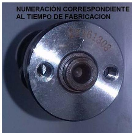
**Gráfico 2** Cada árbol de levas, tiene una numeración concreta, que determina la partida de fabricación, y sus características. Al verificar, éste será un punto a revisar, buscando igualdad. Además, las medidas exactas serán determinadas en otros gráficos (Grf 3)
