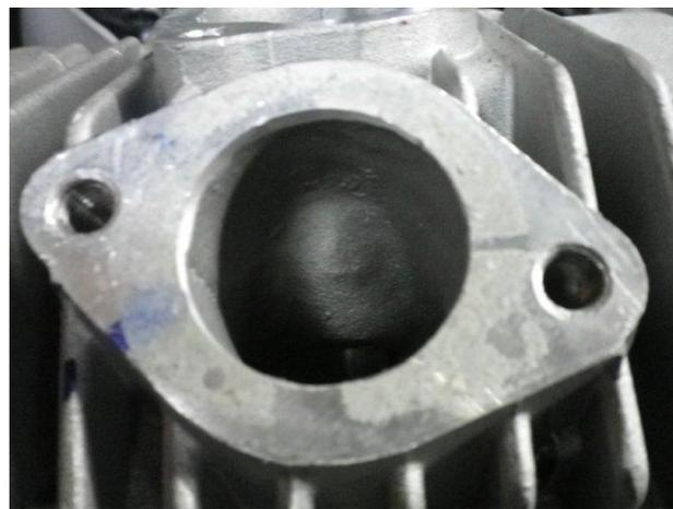
**Gráfico 9** Rugosidad de los conductos en acabado de fundición, no solo aluminio mate, si no en acabado no correspondiente a chorro de arena. Tanto en admisión como en escape.
