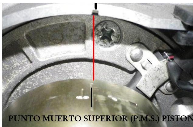
**Gráfico 7.2** Punto muerto superior (P.M.S.) del pistón, medido con el testigo del volante magnético y cárter. Para el funcionamiento correcto del motor, debe coincidir esta posición exacta, con la del gráfico 7.1
