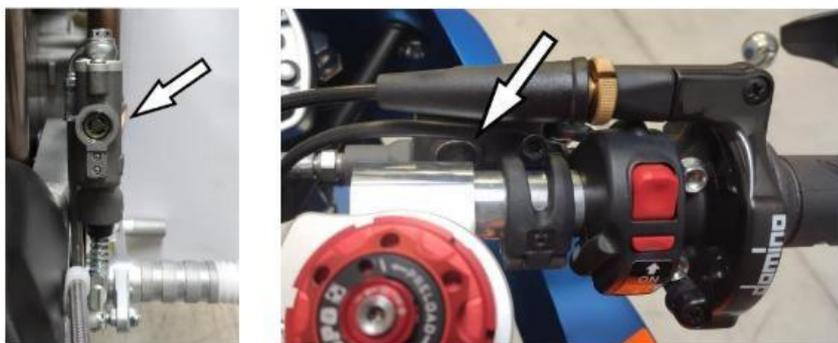
Es aconsejable cambiar el líquido de freno cada 10 horas o después de una carrera en lluvia.
