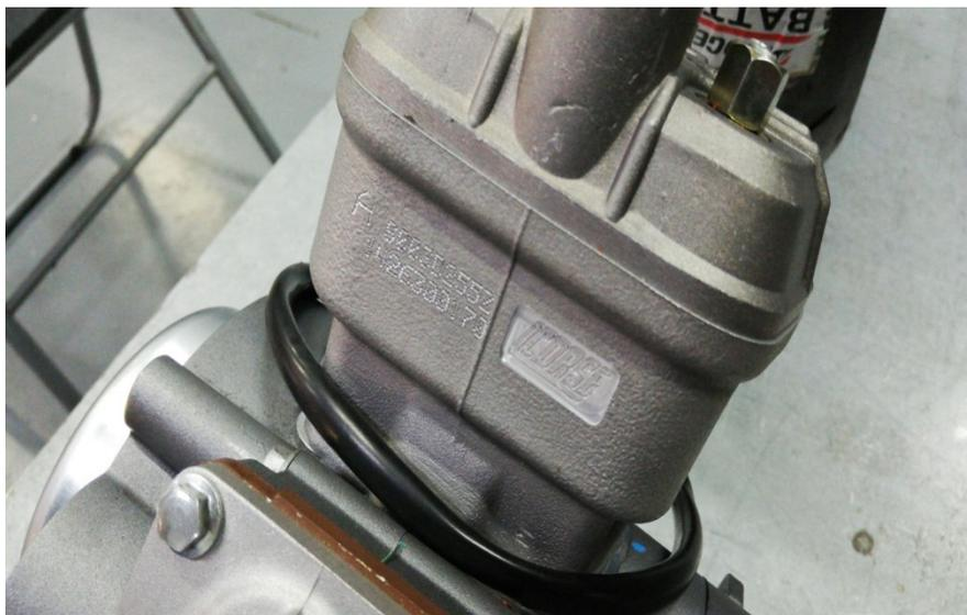
Se podrán sustituir la junta de base de cilindro, con el fin de adaptar la potencia a la necesidad del funcionamiento del motor , al tipo de circuito. No se permite su modificación.
