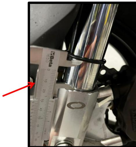
Para medir dicha distancia, con un pie de rey, mida desde debajo de la tórica hasta la parte superior de la marca del tope, y la distancia en mm que nos dé será la distancia a la que estamos del tope mecánico.
