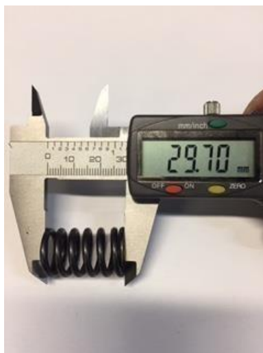
Ilustracion 10: Medicion de los muelles de embrague
