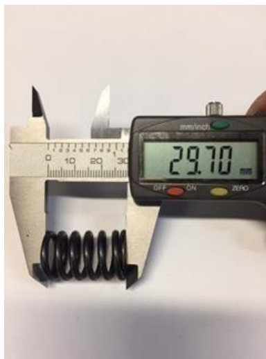
Ilustracion 10: Medicion de los muelles de embrague
